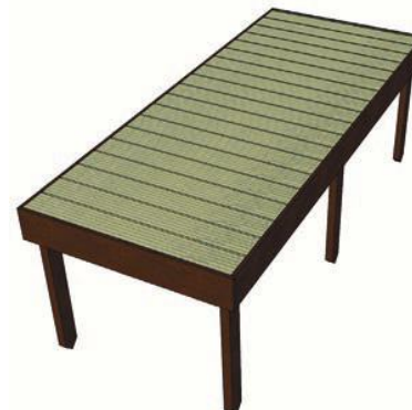
Vlonder met frame- en regelwerk en met fundering Fundering bestaat uit: Hardhouten piketten 100cm M8 slotbouten
