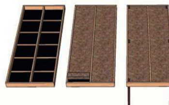
Vlonder met frame- en regelwerk en met fundering Fundering bestaat uit: Hardhouten piketten 100cm M8 slotbouten
