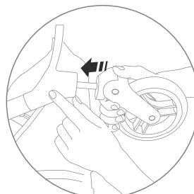
Afmontering: Tryk på den røde knap, og træk hjulet ud for at afmontere.
